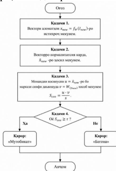
Расми 1 - Блок-схемаи алгоритми тасдиқи шахсият
